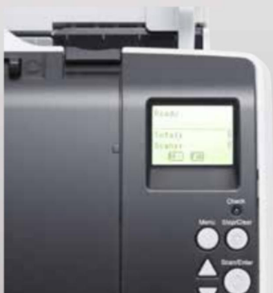
Panneau de contrôle intégré avec écran LCD rétroéclairé
